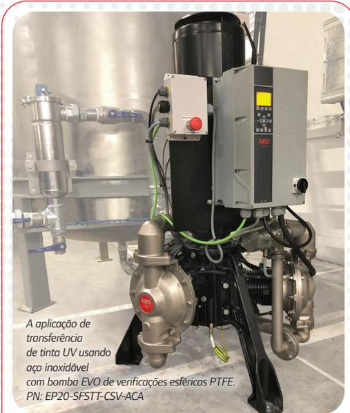
A aplicação de transferência de tinta UV usando aço inoxidável com bomba EVO de verificações esféricas PTFE. PN: EP20-SFSTT-CSV-ACA
