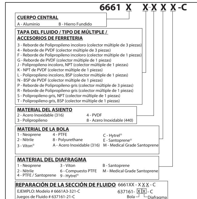
gama de opciones de compatibilidad de material. Consulte el cuadro de modelos y opciones. Las bombas de ARO ofrecen un diseño de resistencia contra los atascos, un motor de aire modular y secciones de fluido.
